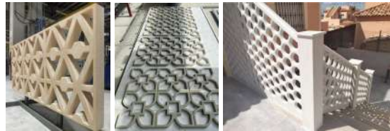
Hình 7. Sản phẩm kiến trúc sử dụng sợi POM dễ dàng trong khâu hoàn thiện bề mặt, góc cạnh.
