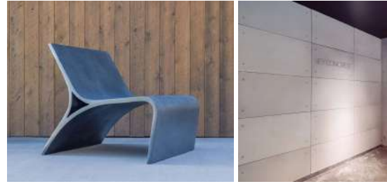
Hình 6. Việt Nam có thể chế tạo các sản phẩm trang trí từ UHPC sử dụng sợi POM.
