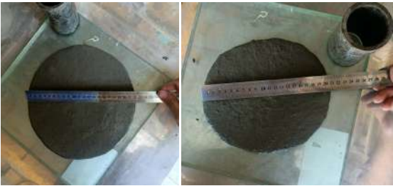
Hình 11. Kiểm tra độ chảy xòe hỗn hợp bằng nhớt kế Suttard.
