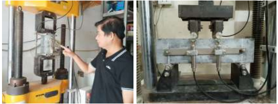
Hình 14. Kiểm tra cường độ chịu kéo và uốn. Bảng 13. Cường độ chịu uốn của các mẫu sau bảo dưỡng nhiệt ẩm (R28 – MPa)
